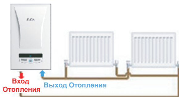
Рисунок 8. Схема подключения устройства СН
