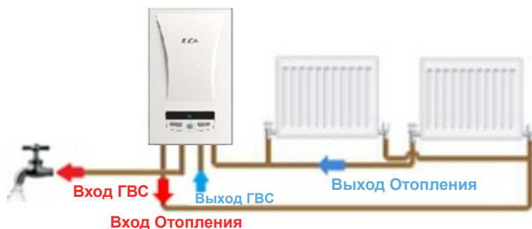
Рисунок 7. Схема Подключения Установки Монотермического Устройства.
